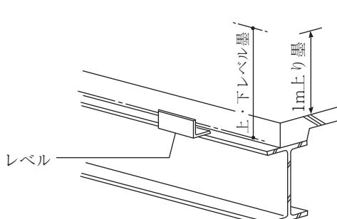
プラケット外面に基準墨から追い出したレベル墨を施工図と照合して墨出しする。
