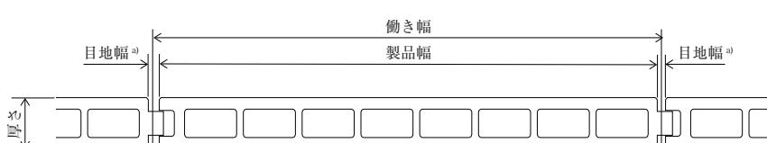
注<sup>a)</sup> 製品幅が900mm以下の場合は標準目地幅10mm、製品幅が900mmを超える場合は標準目地幅15mmとする。
