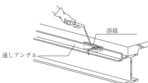
通しアンダルをプラケットのレベル墨に合わせ万力にて仮固定する。
