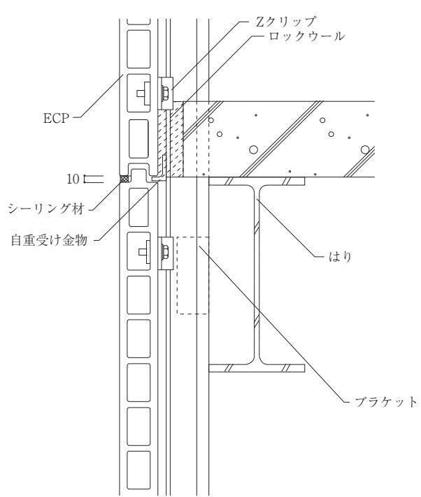
図5-4 横張り工法中間部標準詳細図
