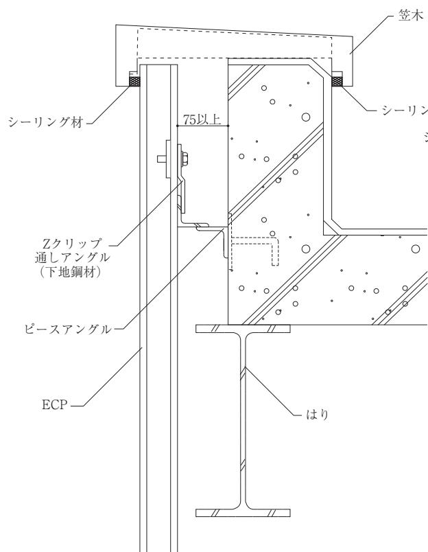
図5-7 縦張り工法上部標準詳細図
