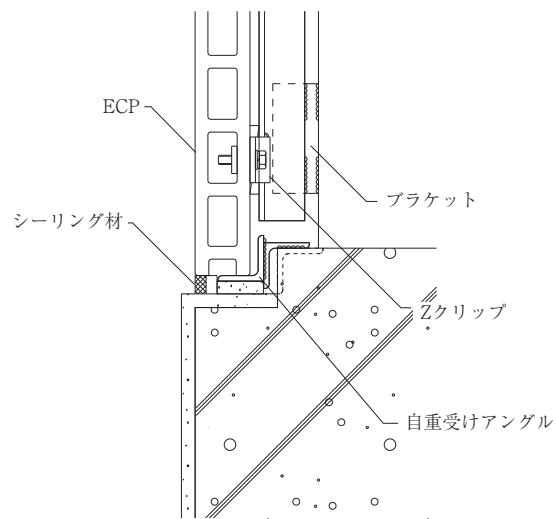
図5-6 横張り工法下部標準詳細図
