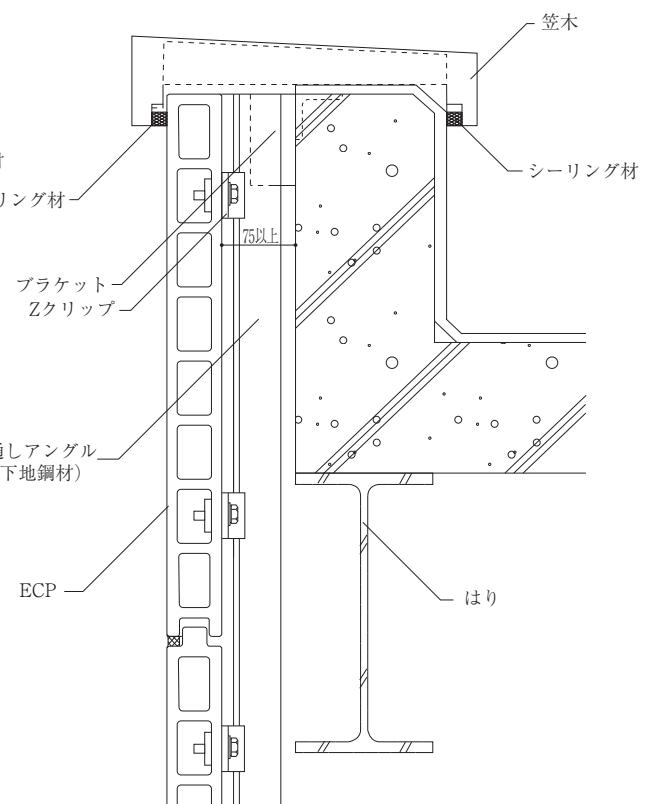
図5-8 横張り工法上部標準詳細図
