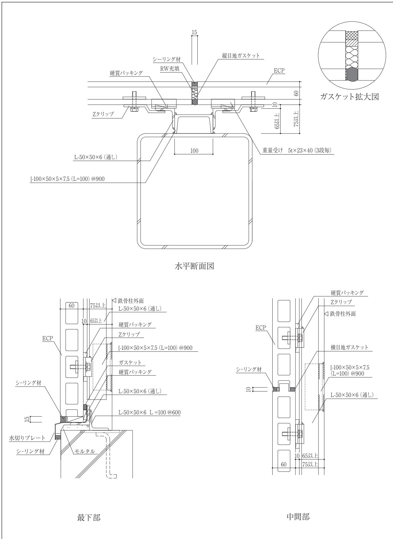
※下地鋼材を軸体鉄骨に直接溶接しない仕様の建物は、捨てプレートを軸体鉄骨に工場溶接し、これに下地鋼材を溶接する。
