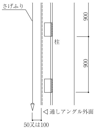
基準墨より、通しアングル外側に下げ振りを下ろし、精度良く万力にてブレケットに固定する。
