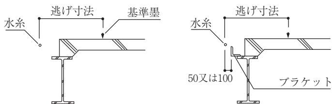
基準墨又は返り墨から下地鋼材の取付け箇所に水糸を張るかまたは下げ振り等で躯体精度を確認する。
