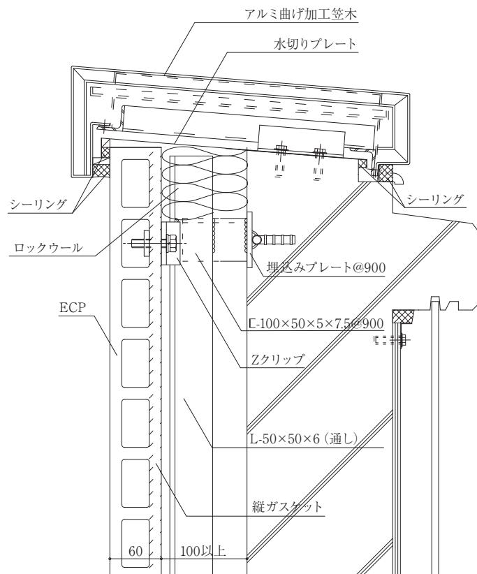
4-22 開口部垂直・水平断面詳細図
