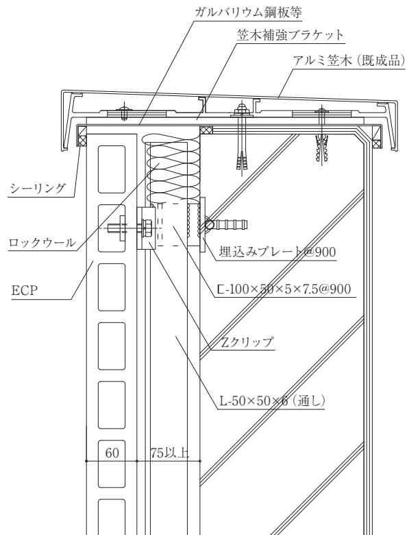
4-10 開口部垂直・水平断面詳細図
