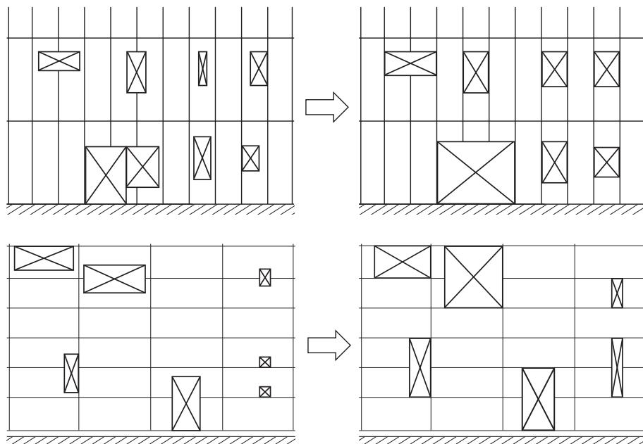
(3) 開口の周囲には補強材を設け、開口部にかかる風荷重は、補強材によって直接躯体に伝えなければならない。補強材の大きさはP10～11による。
