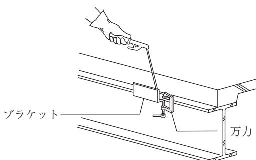
水糸を基準に精度良くプラケットを所定のピッチで梁天端に万力で仮固定し、溶接していく。
